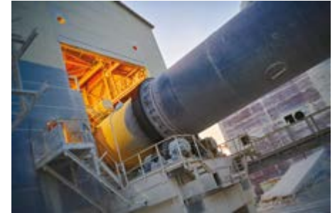
Horno rotatorio de cementera a +/- 1450°C
