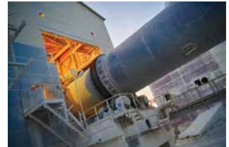
Four rotatif de cimenterie à +/- 1450°C
